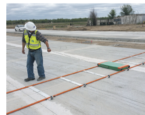
MIT-SCAN iekārta dībeļu pozīcijas noteikšanai.
